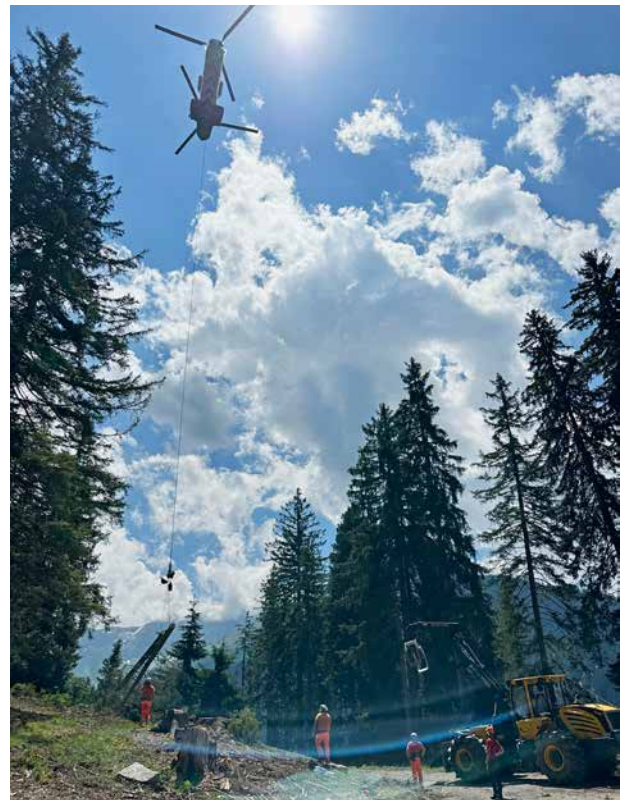
Der Schwerlasthubschrauber Typ Columbia beim Absetzen der Last.
